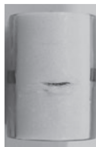
ガラスフィルムを折り曲げた部分(左) シャープエッジテスターにできた切傷(右)
