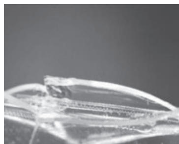
ガラスフィルムを折り曲げた部分(左) シャープエッジテスターにできた切傷(右)
