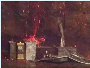
カセットこんろに金網を乗せて炭起こしに使用した結果、カセットボンベが破裂しました!!
