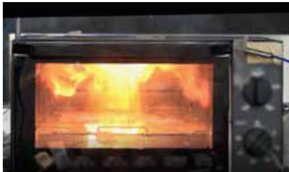
生魚を直接網に載せて加熱した再現試験での発火状況
