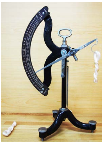
生糸などの太さや 密度をはかる検位衡 (東京都計量検定所蔵)
