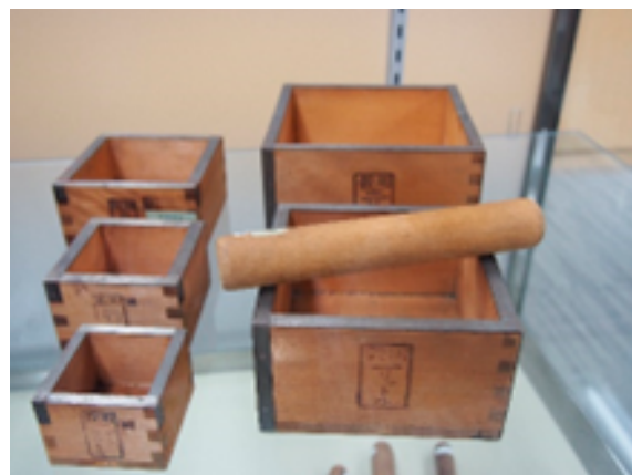
リットルますとデシリットルます （東京都計量検定所蔵）
