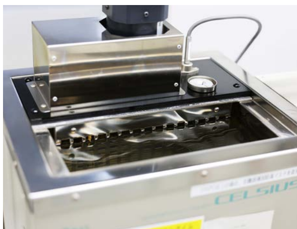
現在の温度計検定用温槽
