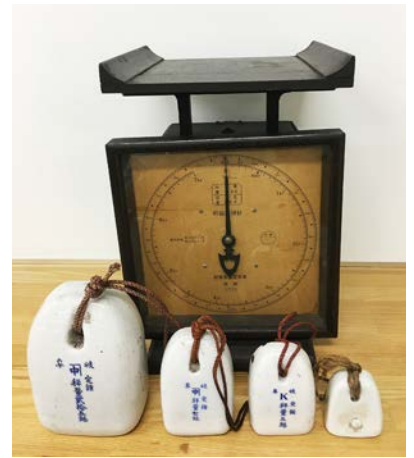
戦時中の木製はかりと 陶器製分銅 (東京都計量検定所蔵)
