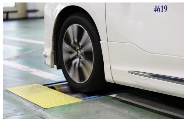
検査用ローラーの上でタイヤを回しているところ
