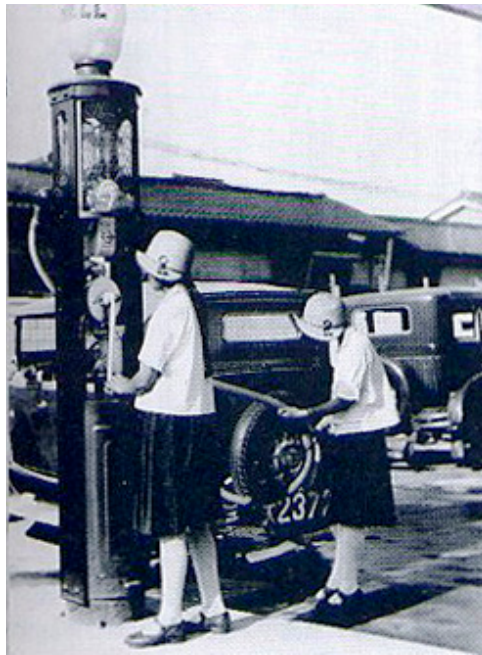
ハンドルを回してガソリンを入れる （東京都計量検定所蔵）
