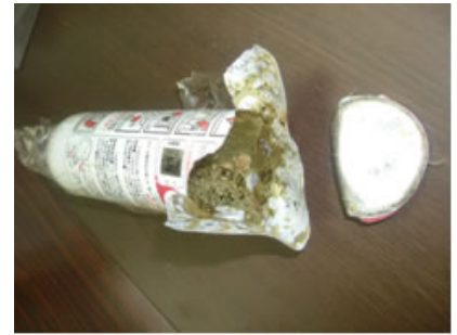
（破裂したエアゾール式簡易消火具）
