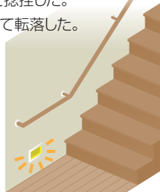
手すりと足元灯
