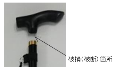
図 5-1 握りの支柱と取付け強度試験の破損 (破断) 箇所
