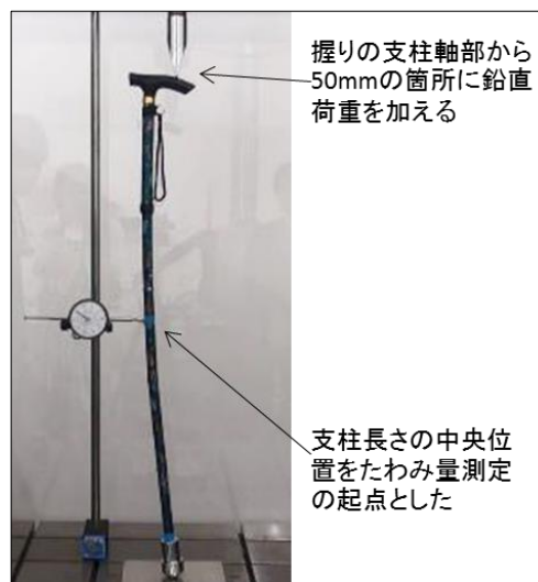
図 4-2 圧縮試験方法
