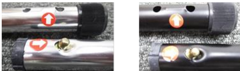
図 5-2 組付部圧縮試験結果（検体 C、左：1回目、右：2回目）
