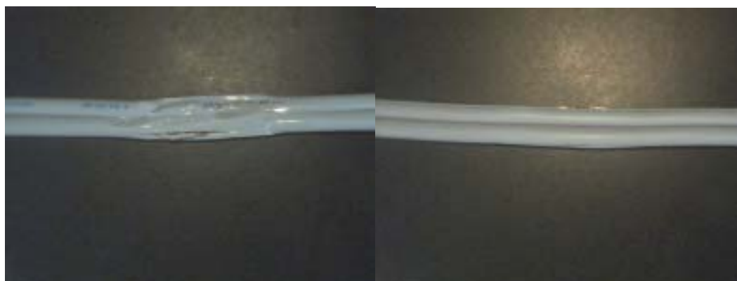
写真4 実験で発煙したコードと半断線コード
