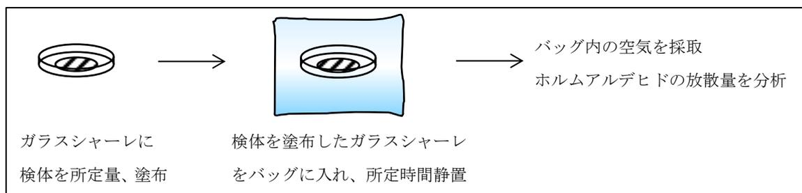
図3 放散試験フロー（概要）
