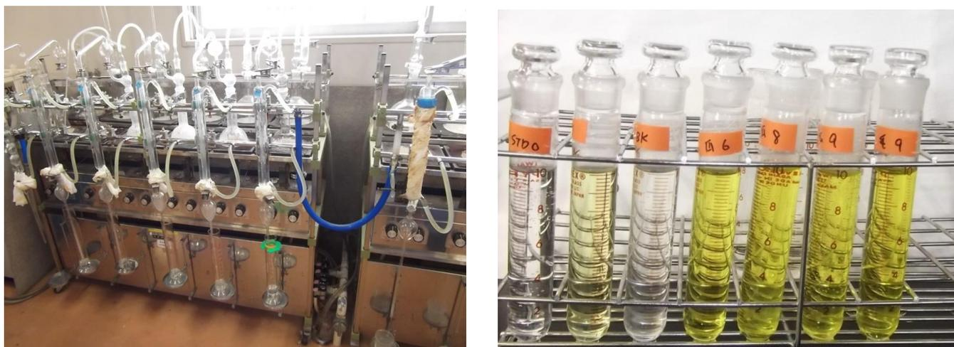
図4 溶出試験の試験過程（左：試験溶液調整のための水蒸気蒸留の様子、右：試験溶液等にアセチルアセトン試液を添加し40℃加温、30分間放冷後の様子）
