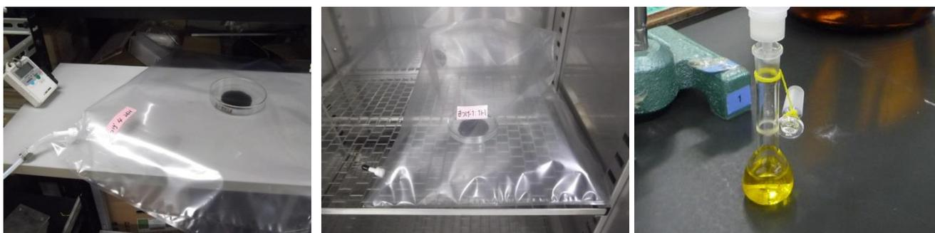
図 5 放散試験の試験過程（左：試験片を入れたバッグに湿度 50%清浄空気を封入、中央：試験片を入れたバッグを温度 28±1℃で静置、右：アセトニトリルでバッグ内ホルムアルデヒドを溶出）
