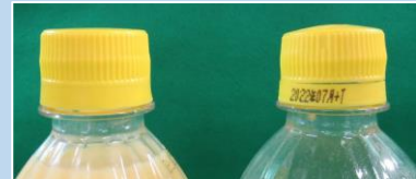
▲内圧上昇により膨らんだキャップ （試験前（左）と試験後（右））
