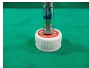
図IV-1 圧力計の固定状況
