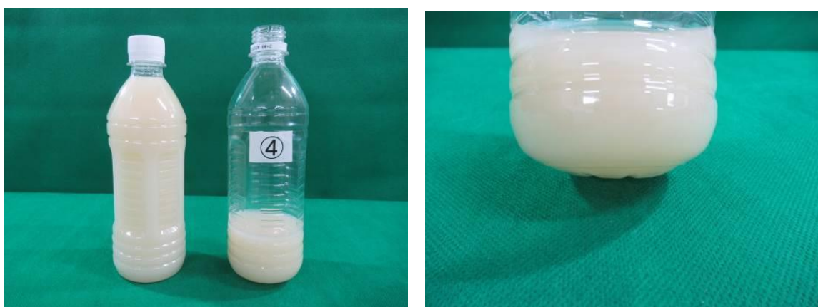
図Ⅳ-14 (左) 検体 4 と未開封との比較 (右) 容器の底部変形状況
