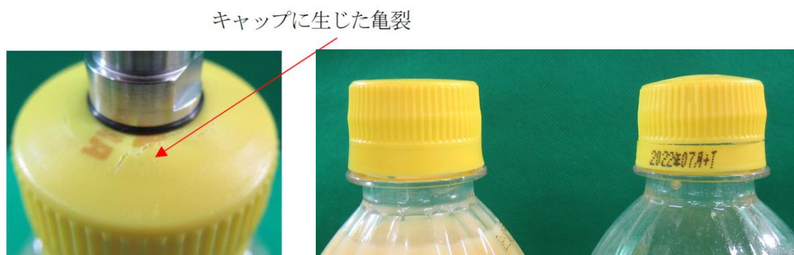
図Ⅳ-13 (左) 検体 1 のキャップに生じた亀裂 (右) 未開封容器との比較
