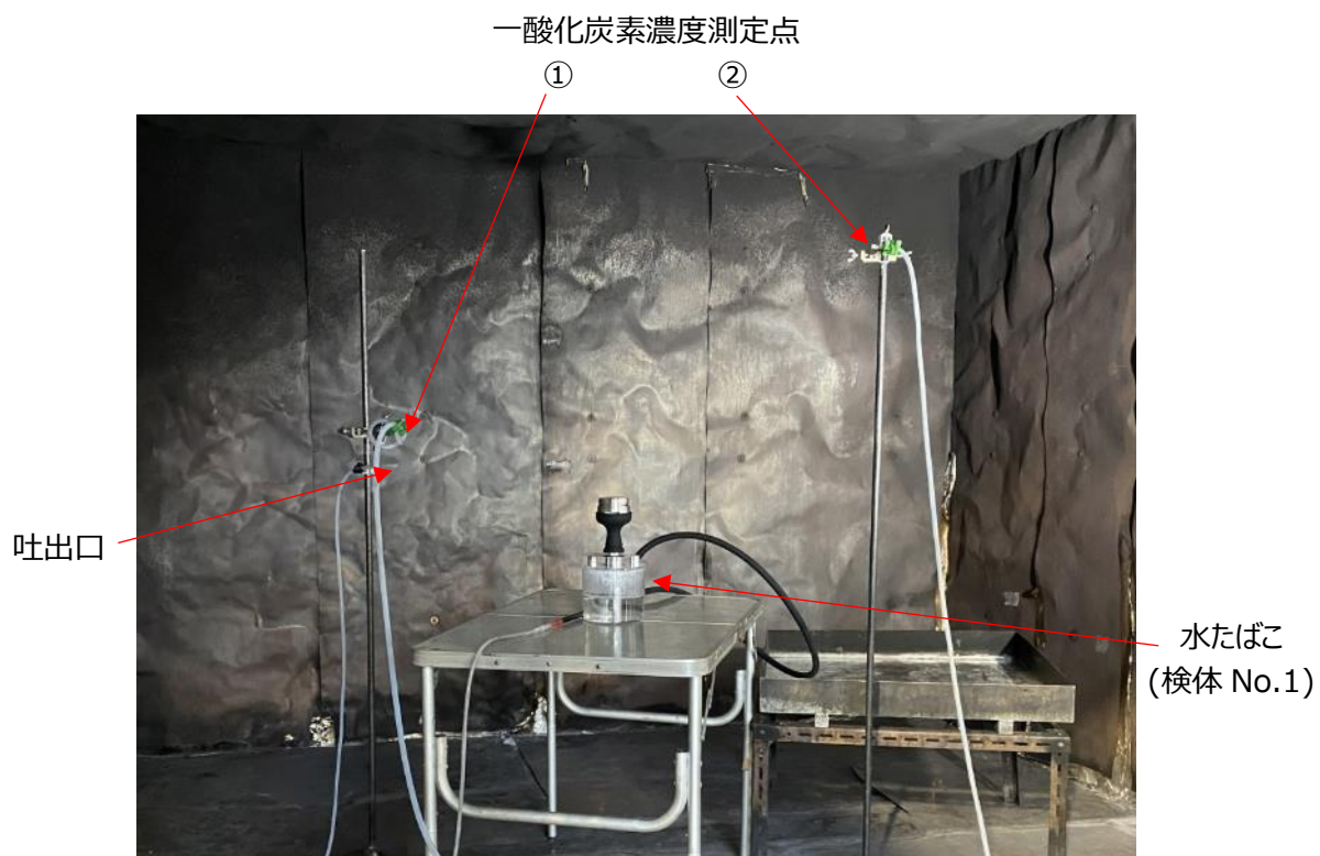
図 46 屋内空間で 1 検体（検体 No.1）使用時の試験実施状況
