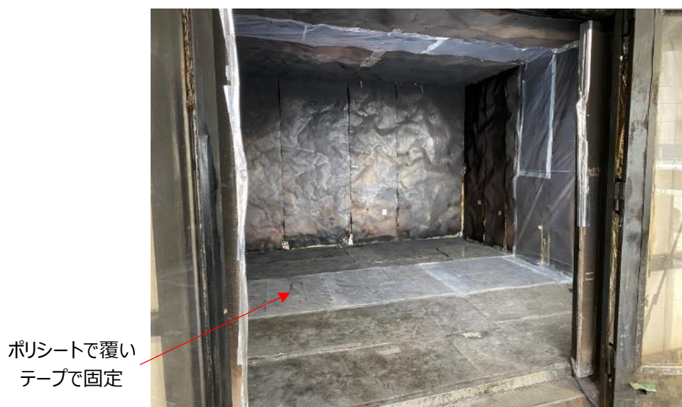
図 44 目張りを実施した試験チャンバー
