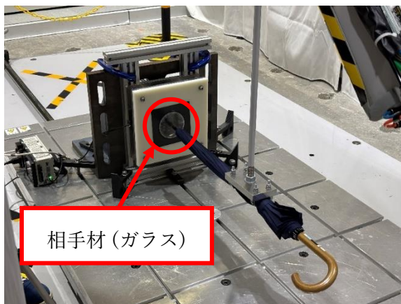
図 38 試験状況 (傘の横持ち衝撃可視化)
