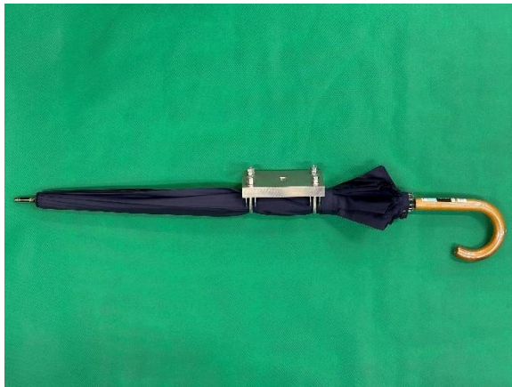
図 32 傘固定用治具に傘を固定した状態
