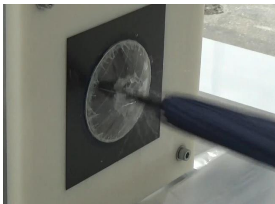
図 43 雨傘の石突きが衝突した直後のガラスの様子
