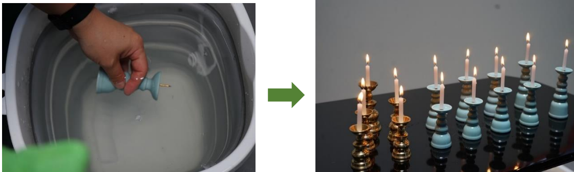
図IV-6 水で濡れた燭台の火災危険調査
