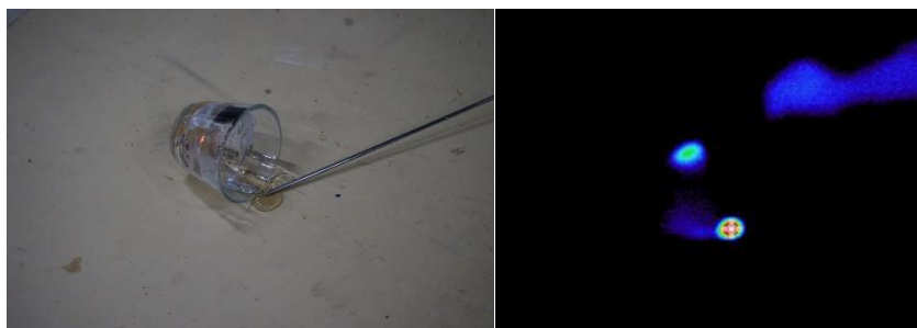
図V-6 ジェル・ガラスの転倒試験 (左)試験写真 (右)サーモ画像
