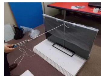
図 3-4 テレビを転倒させるために必要な力の確認試験イメージ
