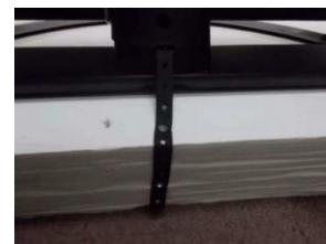
図 3-6 テレビ付属の固定器具設置イメージ
