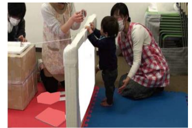
図 3-1 乳幼児による引く力確認試験イメージ
