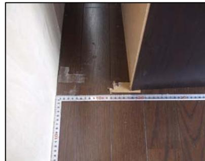
写真 12 加振後の移動状況
