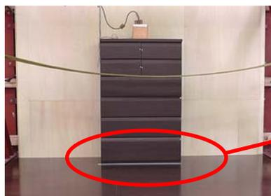
写真2 ストッパー式器具の設置状況
