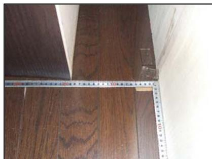
写真 10 加振後の移動状況
