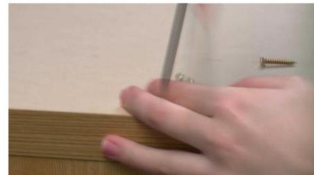
転倒防止用部品を取り付けるために、ドライバーで穴をあけようとしていた。
