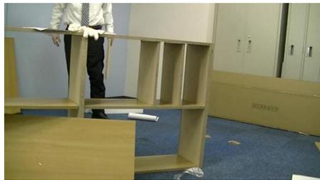
部品の溝に差し込む部品をボンドで取り付けたために、部品が落ちてきた。
