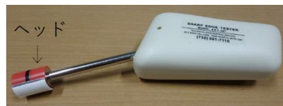
図 III-1 シャープエッジテスター ヘッド部に施した2層の検知テープを、評価する部分に当てて動かし、検知テープが貫通するか確認する。
