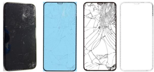
図 IV-2 落下試験後の検体画像の二値化 による破損状況の確認
