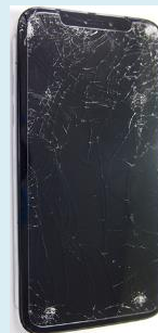
落下試験後の検体（左：全体、右：拡大）
