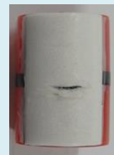
<テスターにできた切傷> テスターヘッド部に施した 2 層の検知テープを貫通した。
