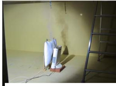
11 分経過後の発煙の状況
