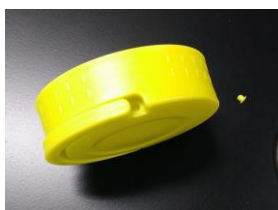
検体 B 蓋部破損状況
