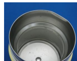
検体 C 容器変形状況
