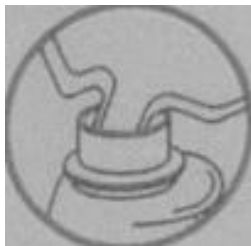
検体 No.19-1 注ぎ口を本体製品 に差し込める形状
