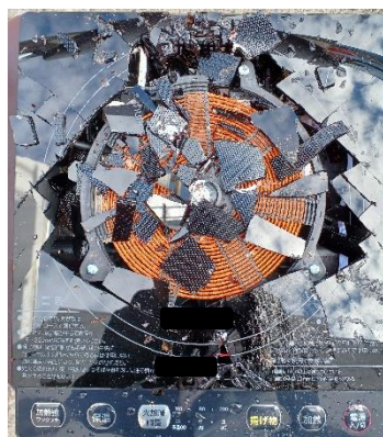
IH クッキングヒーター表面の破損状況
