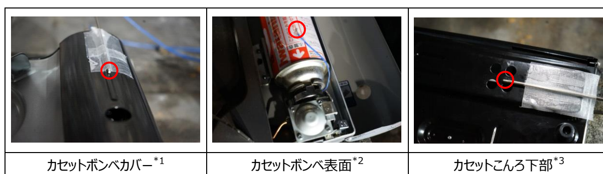
図 45 熱電対の接着状況
