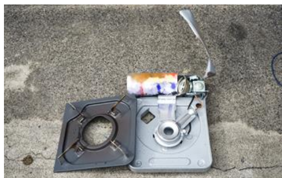
各検体の破損状況
