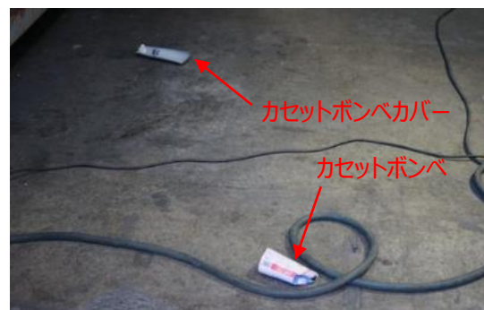
飛散物の状況 (図 47 に示す実験ユニット外の床上)
