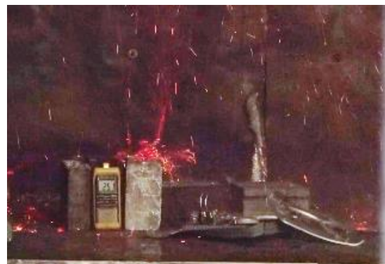
破裂直後(0.9 秒後)に炭が飛散している状況
