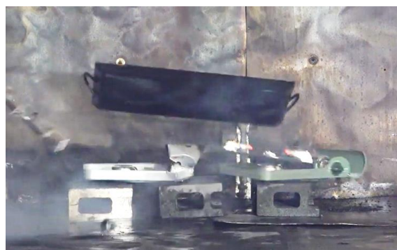
破裂直後(0.23 秒後)に鉄板(大)が飛び上がる状況
