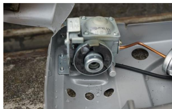
マグネット装着部分の破損状況 (マグネット割れ)
