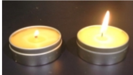
写真5 芯の長さの違う検体の燃烧
