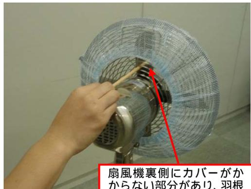
扇風機裏側にカバーがかからない部分があり、羽根ガードの隙間に模擬指が入る
