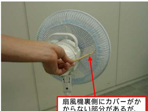
扇風機裏側にカバーがかからない部分があるが、羽根ガードの隙間には模擬指が入らない
