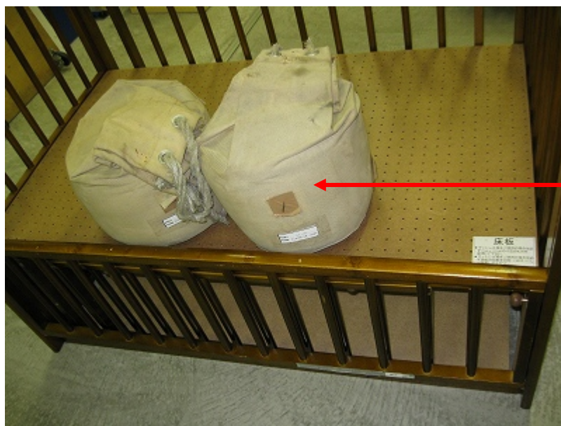
写真5 認定基準項目 15 (床板前縁部静荷重試験)
