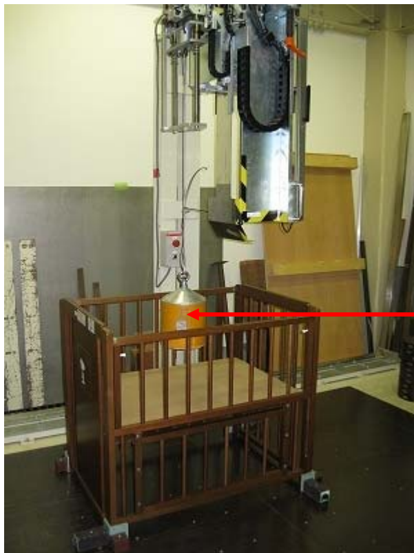
写真1 認定基準項目 11 (床板中央への砂袋繰り返し落下衝撃試験)
