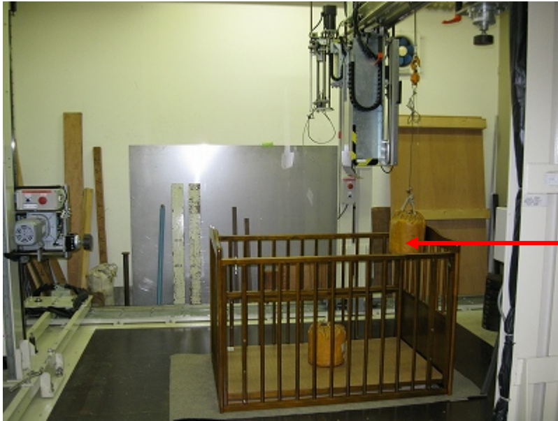
写真8 認定基準項目20（各枠上さんへの砂袋衝撃試験）
