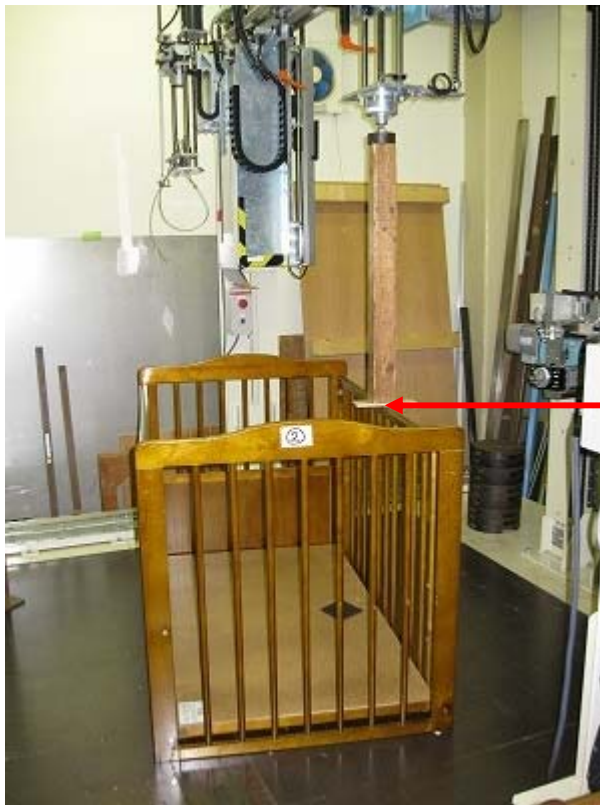
写真2 認定基準項目12 (各枠上さん垂直荷重試験)
