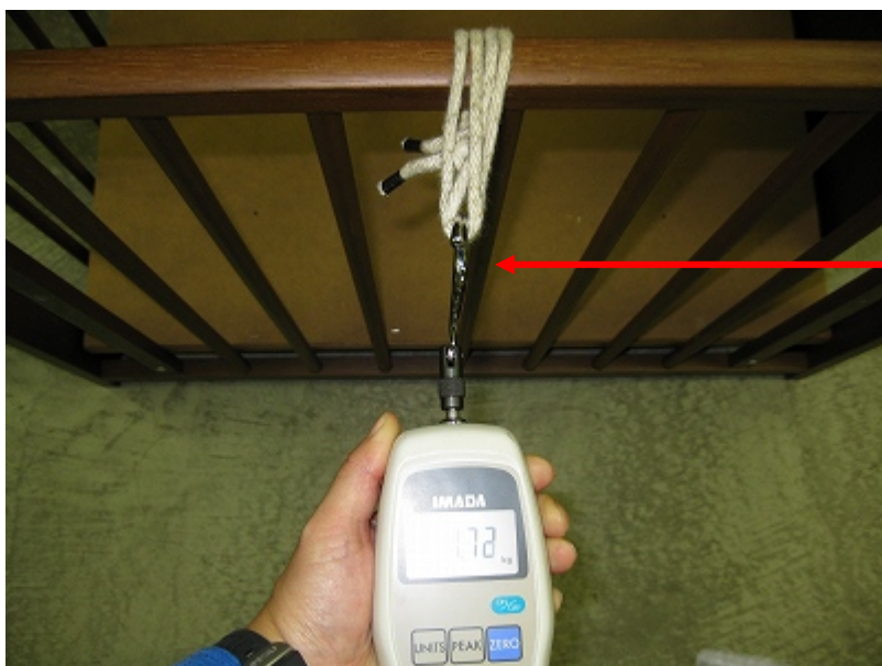
写真4 認定基準項目 14 (各枠上さん水平荷重試験)
