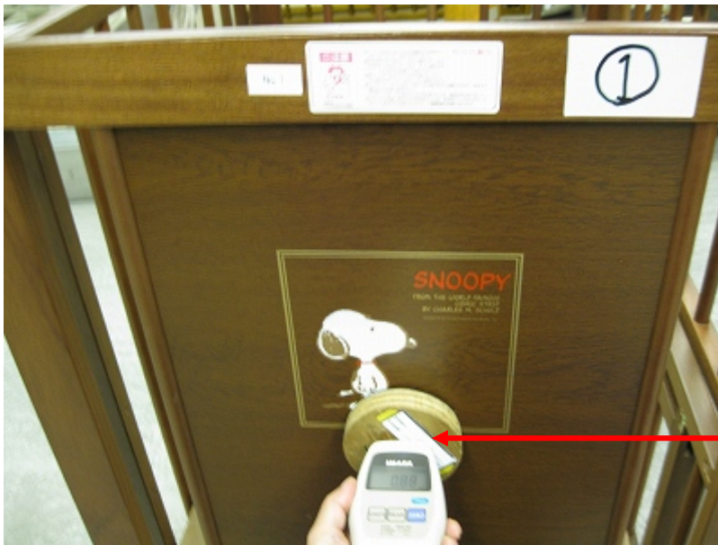
写真6 認定基準項目16 (板(又はネット)中央部への水平荷重試験)
