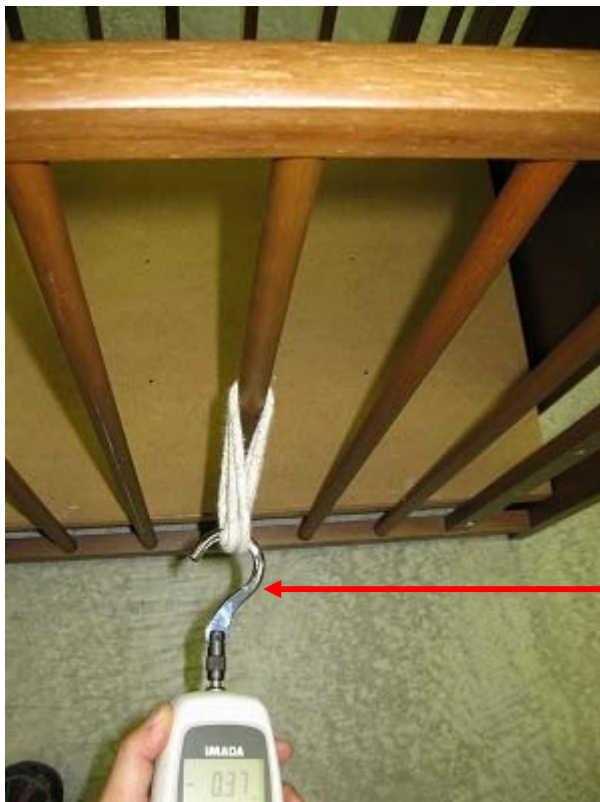
写真3 認定基準項目13 (組子中央部引っ張り試験)
