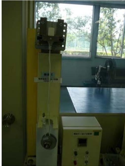
電線折り曲げ試験装置
