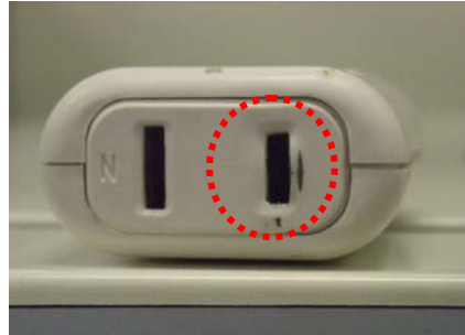
開閉試験後の差込口
