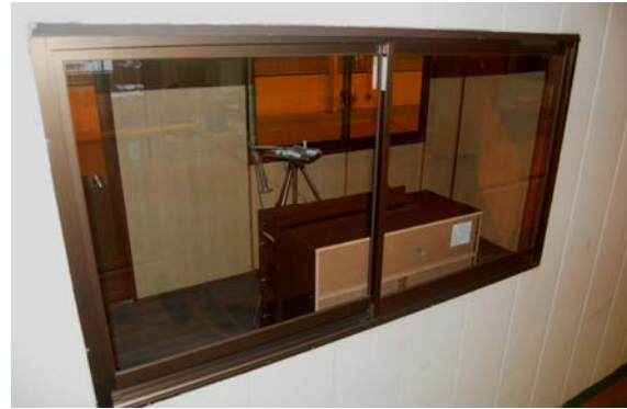
写真4 室内濃度試験実施状況
