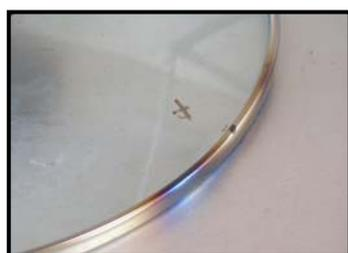
写真 6.1 加熱による変色
