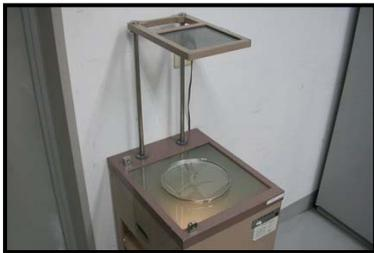
写真 5.1 ひずみ検査器
