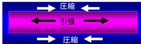
図： 強化ガラスの力の分布(断面)
