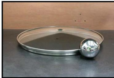
写真 5.2 落球衝撃試験用鋼球
