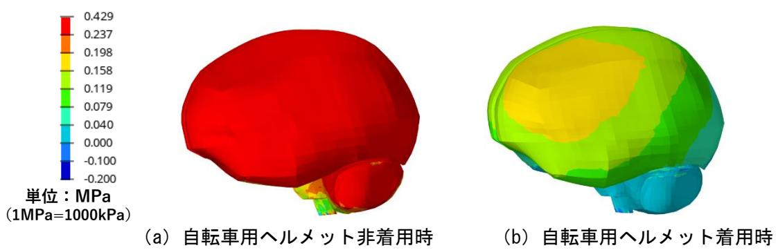
図 7-11 頭部が地面に衝突する場合 脳にかかる圧力（最大時）
