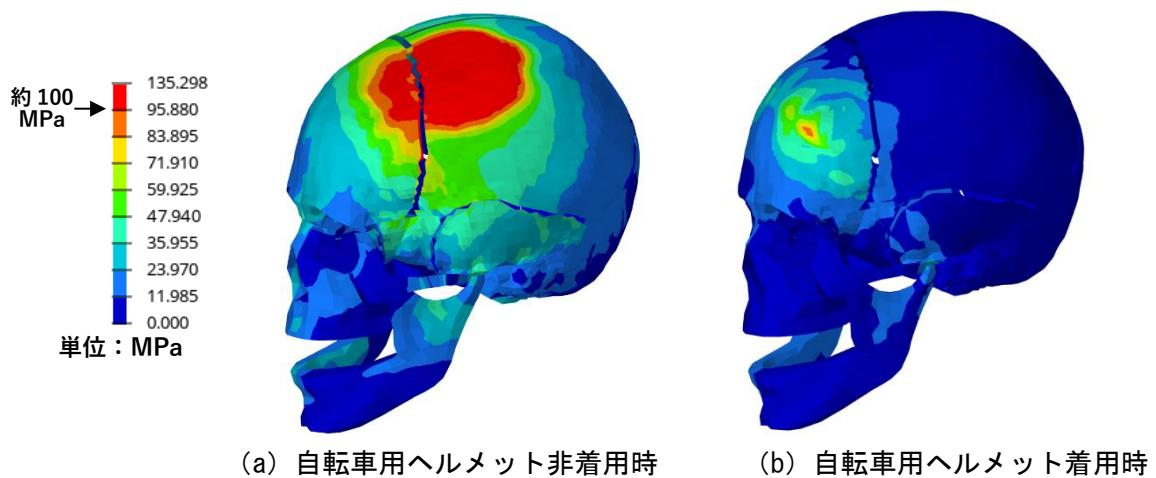
図 7-10 頭部が地面に衝突する場合 頭蓋骨にかかるミーゼス応力（最大時）
