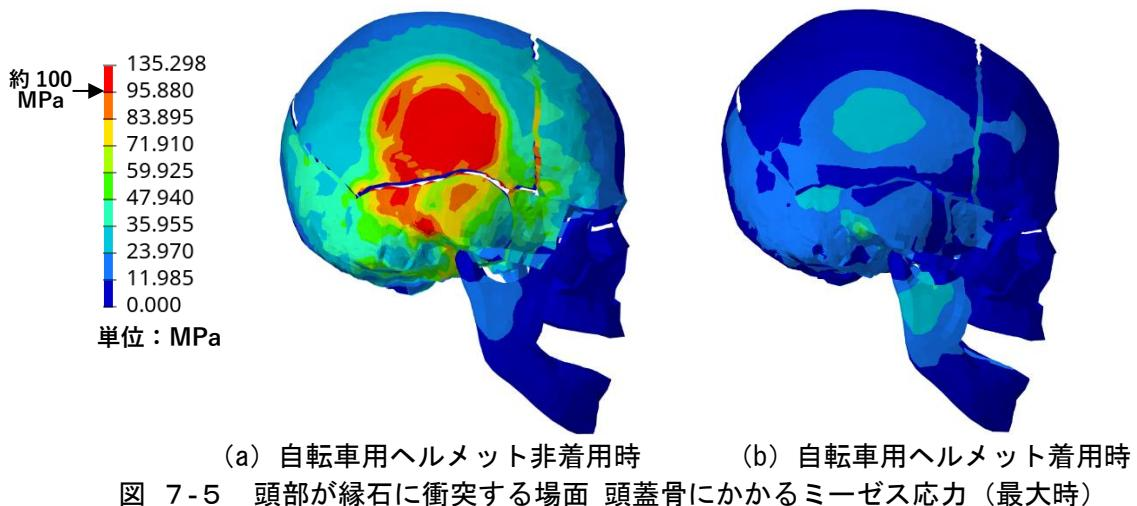
図 7-5 頭部が縁石に衝突する場面 頭蓋骨にかかるミーゼス応力（最大時）
