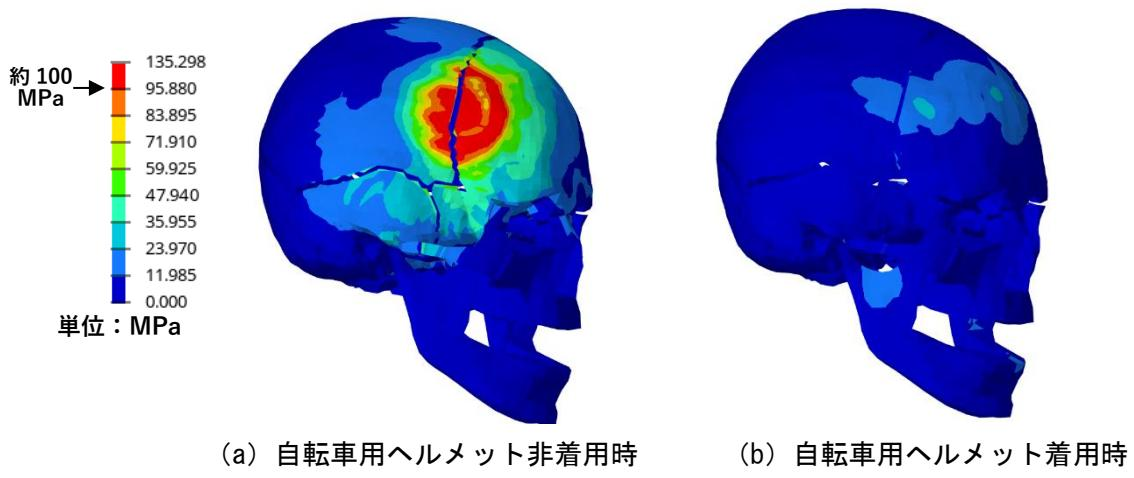
図 7-8 頭部同士が衝突する場面 頭蓋骨にかかるミーゼス応力（最大時）
