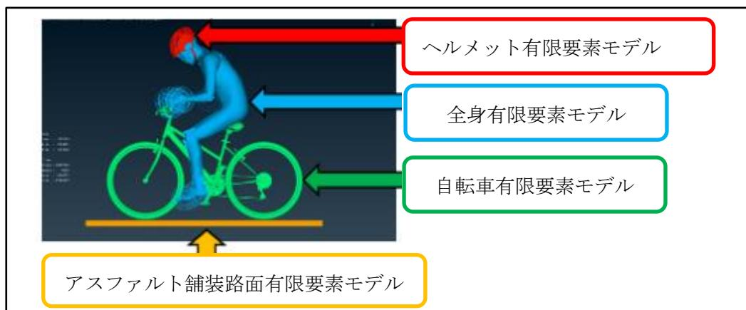
図 7-1 模擬実験に用いたシミュレーションモデル
