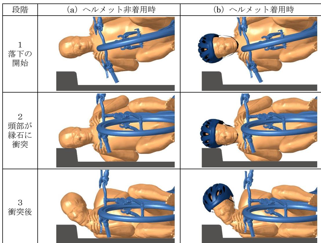
図 7-4 自転車単独の転倒 シミュレーションの様子
