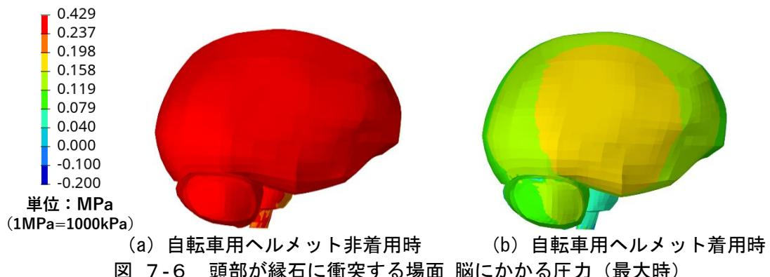
図 7-6 頭部が縁石に衝突する場面 脳にかかる圧力（最大時）
