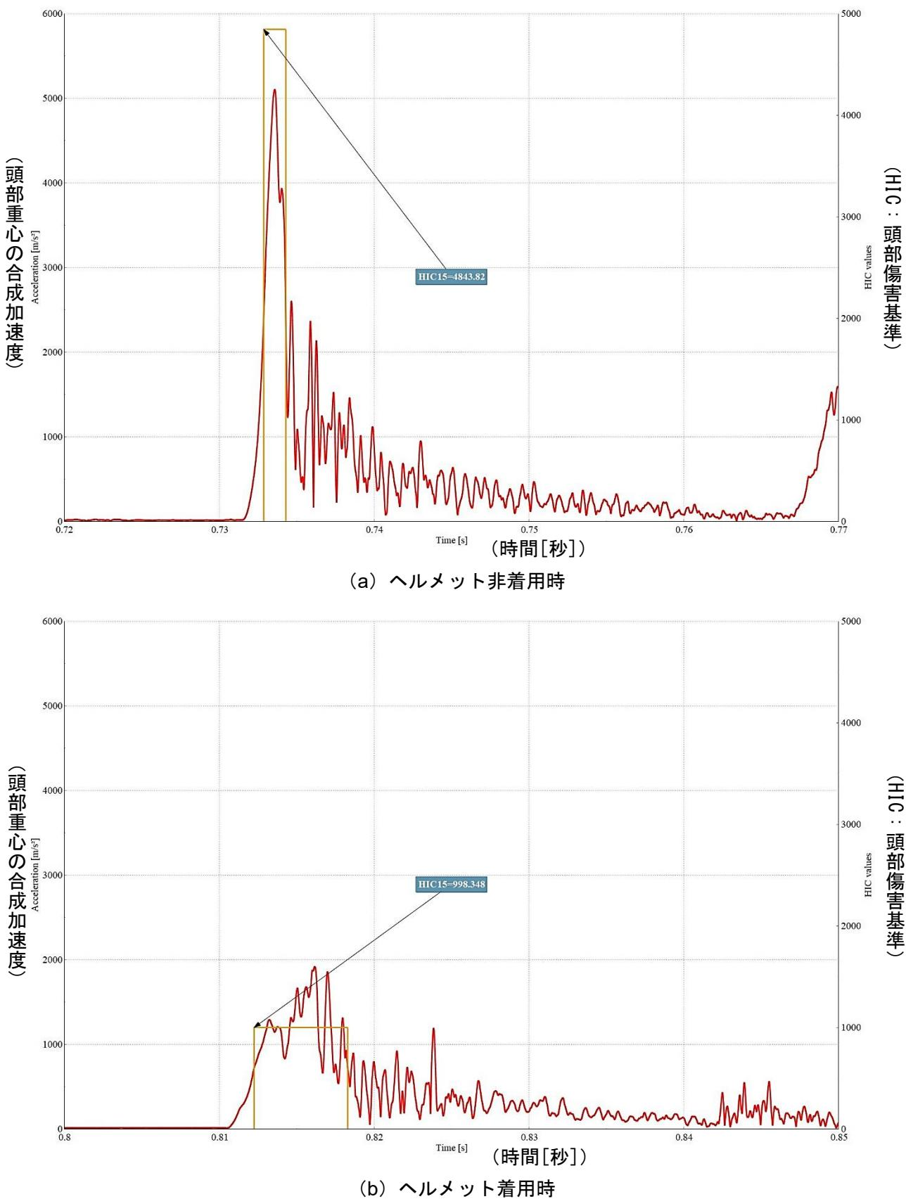
図 7-14 頭部が地面に衝突する場面 HIC・頭部重心の合成加速度
