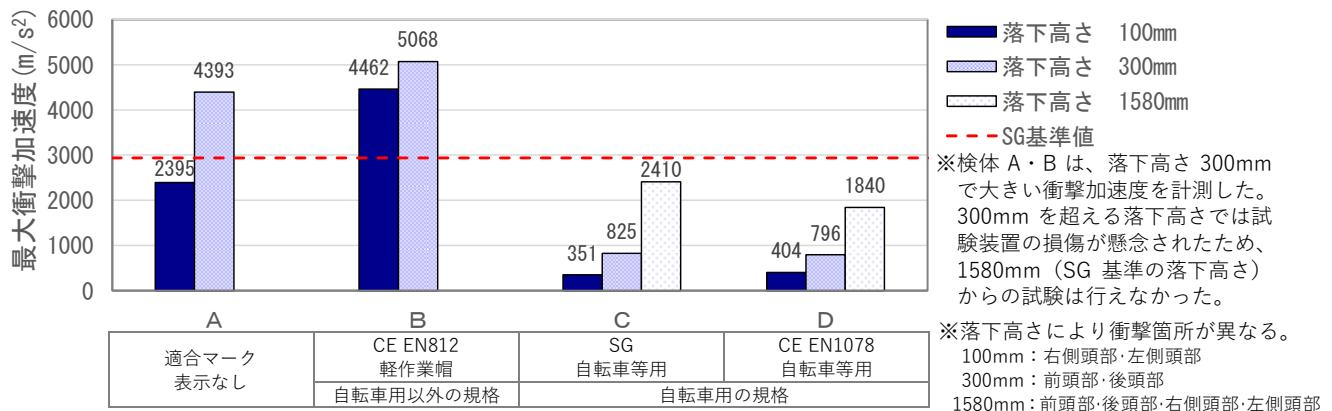
図 8-2 最大衝撃加速度の比較 検体別 (平面形鋼製アンビル)
