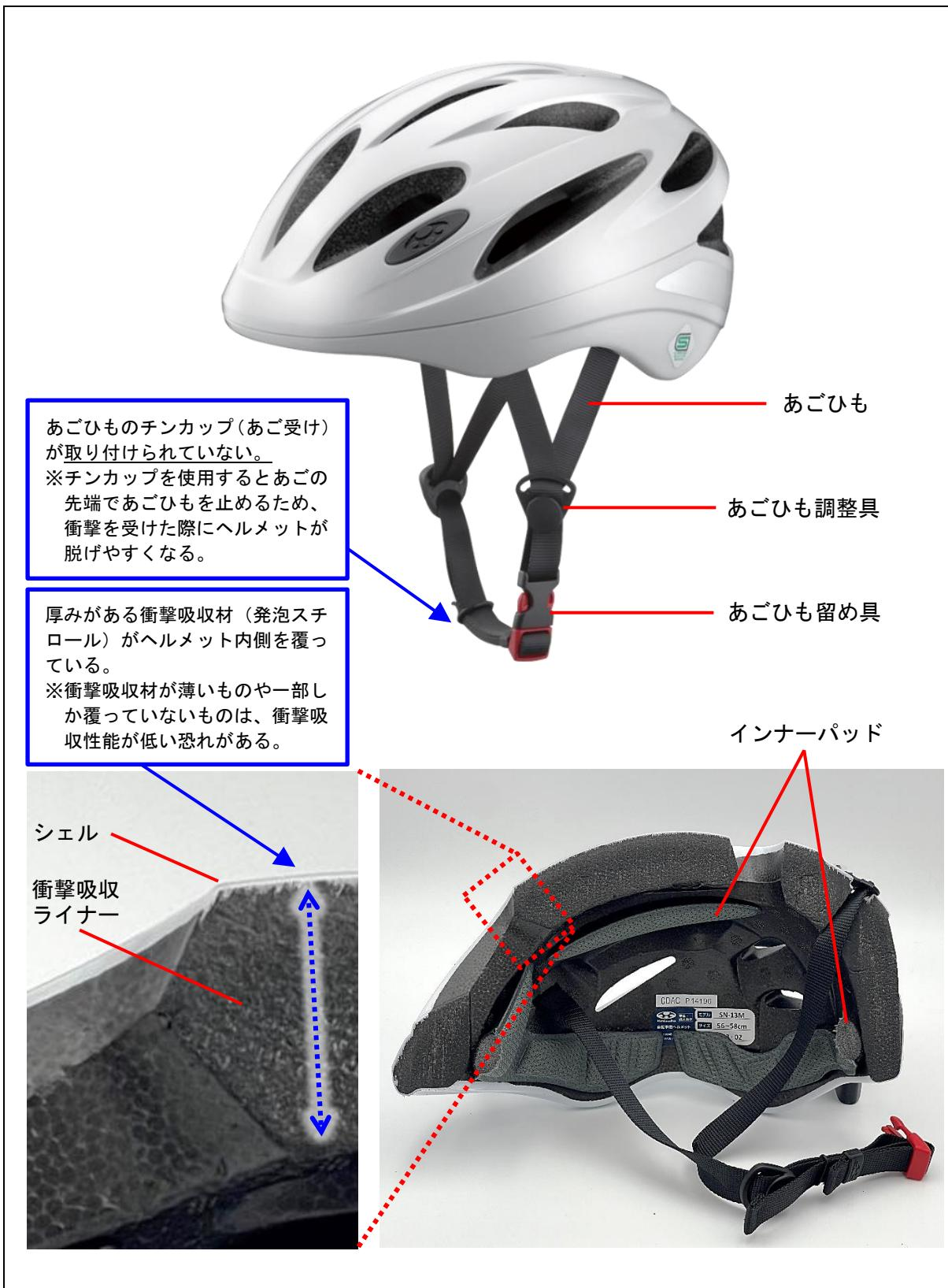
図2 自転車用ヘルメット（SG認証品）外観及び断面写真<sup>1</sup>
