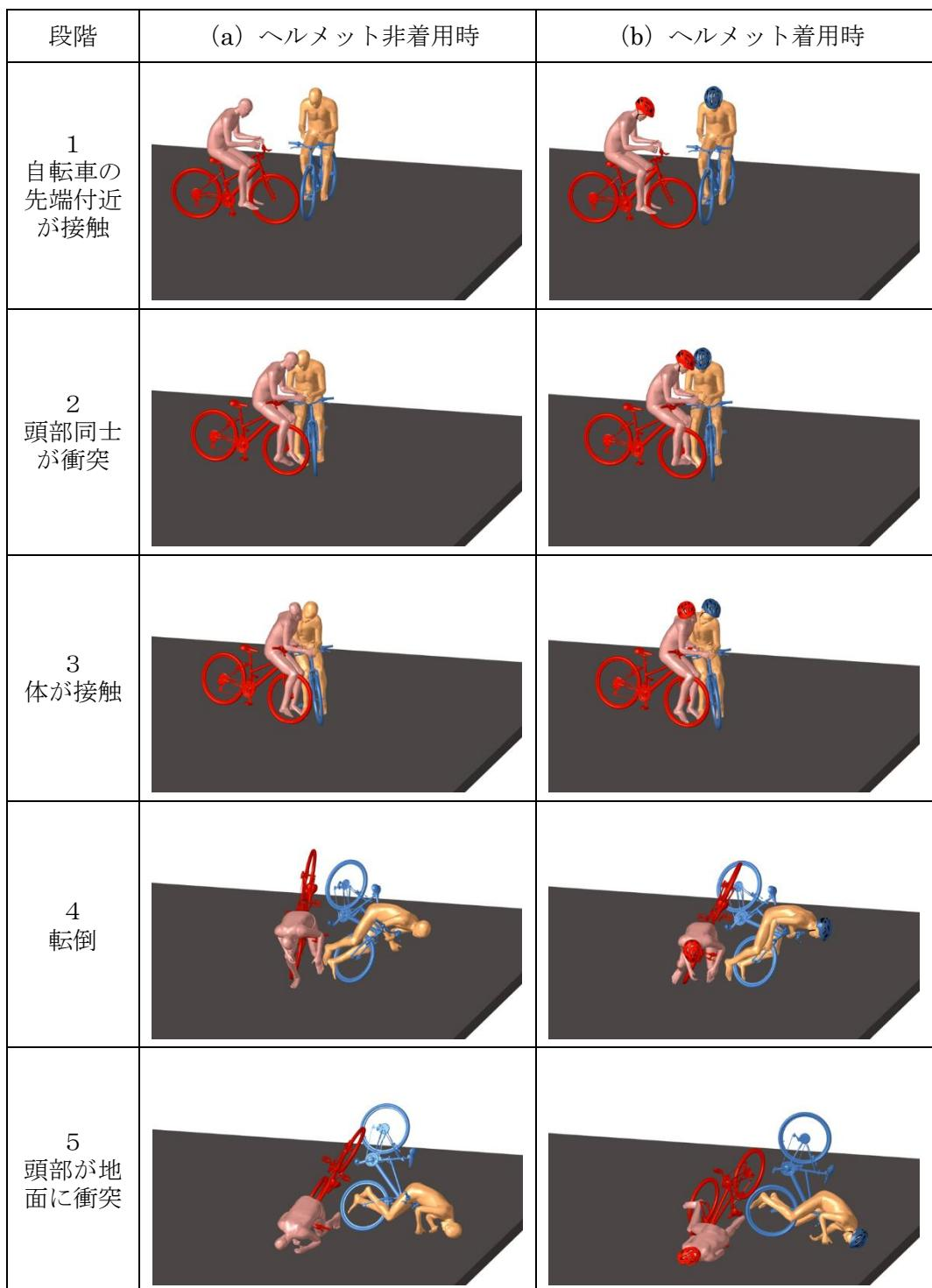
図 7-7 自転車同士の衝突 シミュレーションの様子
