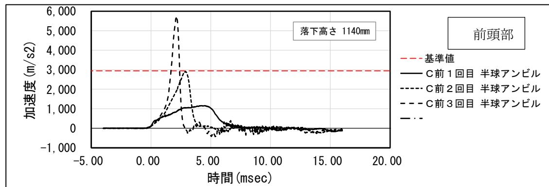
図 8-8 衝撃吸収性試験（繰り返し）の衝撃加速度の時間波形（検体 C 前頭部）
