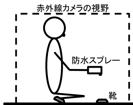
図 4 気流可視化測定模式図 (対象物：床に置いた靴)
