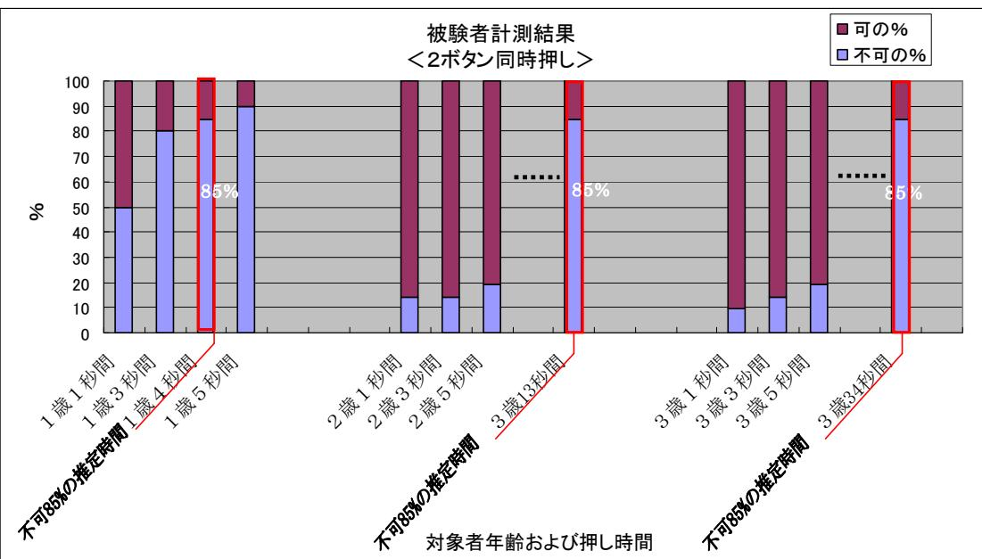
注記 不可 85%の時の推定時間及び推定回数は、計測結果から求めた回帰直線により推定した。
