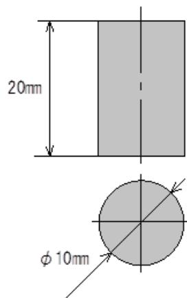
図 2—接触子の例
