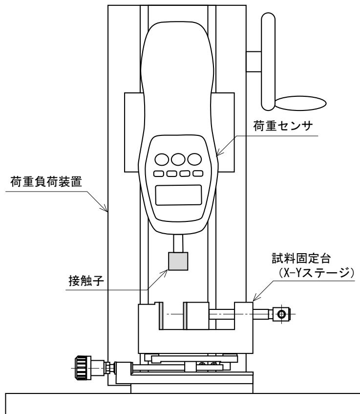
図1－ロック解除力試験装置の構成例
