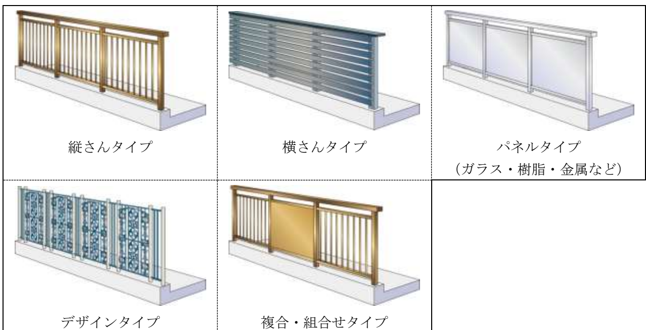
図 2-2 手すりのデザイン別の分類(腰壁なし・腰壁あり(低い))
