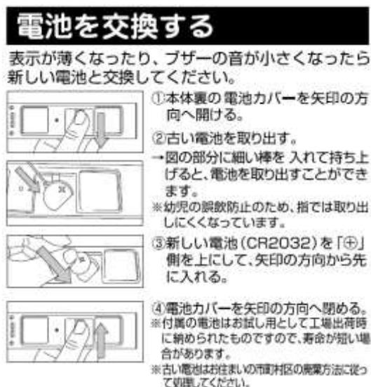
図4-4 取り出しにくくする構造の例
