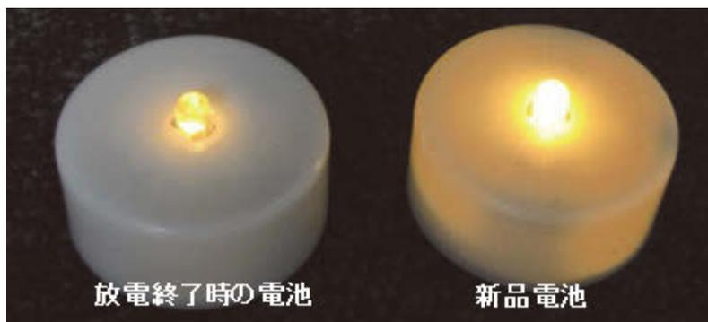
放電終了から約 26 時間後の電圧 (OCV) : 2.741V
