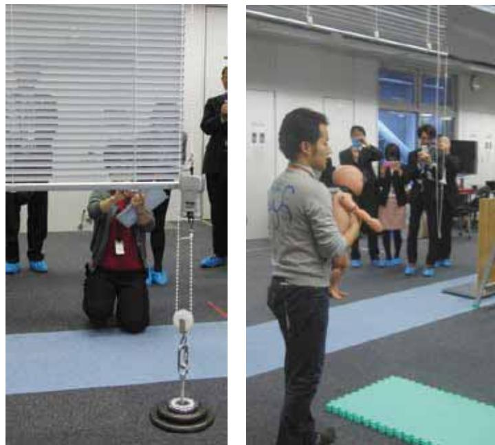
図 3-26 重り、ダミー人形を用いた再現実験状況
