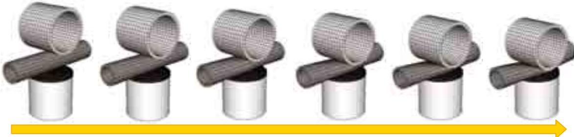
図 12 テストピース（鉛製中空パイプ）の衝撃シミュレーション結果（試験対象 2）
