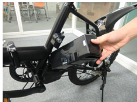
写真 7-8 充電電池の取付部分
