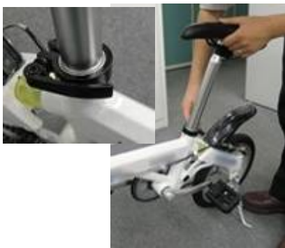
写真 9-5 サドルの取り付け
