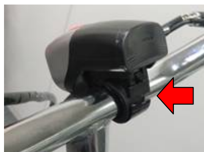
写真 10-6 ライトの破損箇所
