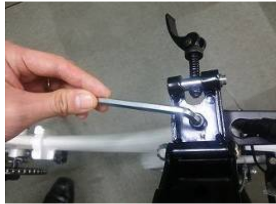
写真 6-2 ハンドル折れ部分の組立て
