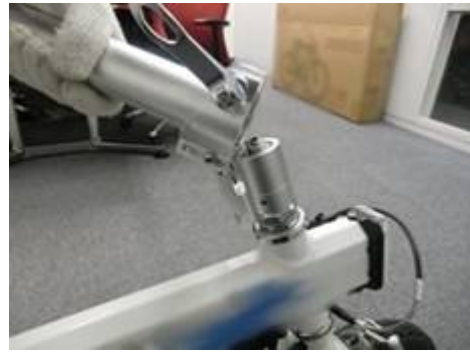
写真 9-2 ハンドル折れ部分
