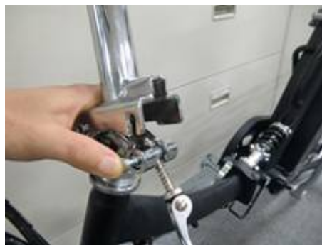
写真 10-2 ハンドル折れ部分
