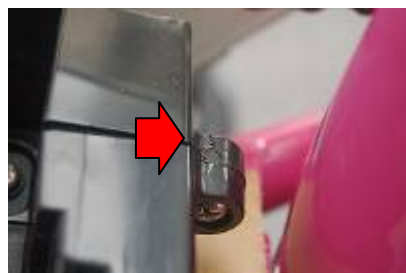
写真 8-7 納品時の亀裂箇所：後部 (その後破損)
