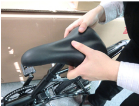
写真 7-5 サドルの取り付け
